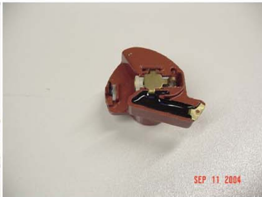
1211 1328 430 Rotor rev limiter B190 - 220 .jpg
